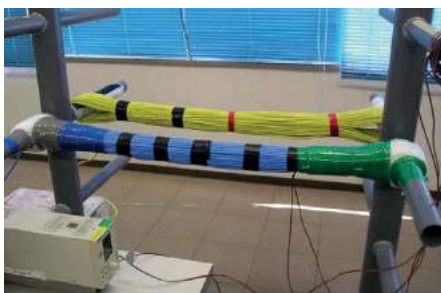
【写真1】91本バンドル時の温度上昇実験の様子
