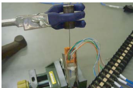
【写真2】ケーブルとモジュラプラグの接続部の温度上昇調査
