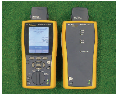
【写真2】フィールドテスタDTX-1800 (チャンネルアダプタ装着時)
