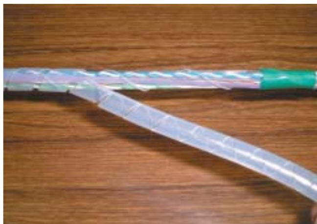
④ PVCスパイラルチューブを巻きつけます(スパイラルチューブの内径4mm~6mm)
