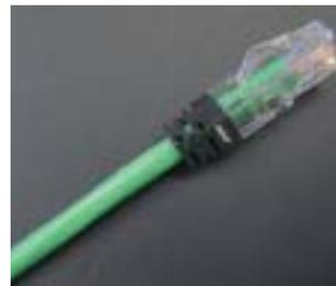
ケーブルの対が、時計回りに青対 橙対 緑対そして茶対と並んでいるとき、T568B用にコネクタ加工しやすいが、T568A用にコネクタを取り付けるには、この対の配列の中で、十文字型介在紐が緑対と橙対の位置入れ替えの邪魔をして対を入れ替えることがしにくい。無理に入れ替えると、リターンロスや漏話減衰量などの劣化を引き起こすことが多い。そのような影響を避けるためにも、従来どおりのケーブル対配列の場合、T568Bの心線配列(ピンアサイン)が適用しやすい。この隔壁などは対のより戻しを最小限にするための効果としては、最も適した構造をもっているのである。
