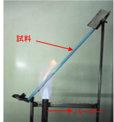
JIS C 3005 60度傾斜試験
